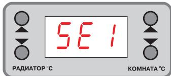
Индикатор мигает и индицирует выходе из строя датчика комнатной температуры. Нагревательный элемент отключен. Необходима замена датчика.
