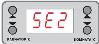
Индикатор мигает и индицирует о выходе из строя датчика радиатора. Нагревательный элемент отключен. Необходима замена датчика.
