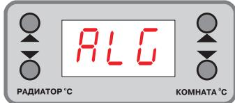
Индикатор светится и указывает на отсутствие заземления. Нагревательный элемент отключен.. Необходимо обеспечить заземление в питающей Сети.
