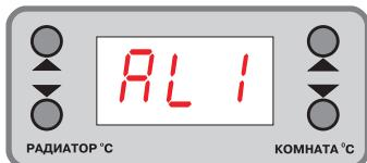
Индикатор светится и индицирует о срабатывании плавкого термопредохранителя. Нагревательный элемент отключен. Требуется замена термопредохранителя.
