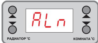
Индикатор светится и указывает на обрыв рабочей "нейтрали" (нулевого провода). Нагревательный элемент отключен.. Необходимо устранить обрыв нулевого провода.
