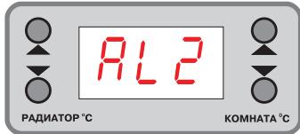
Индикатор светится и индицирует о перегреве радиатора выше 74°C. Нагревательный элемент отключен. Выход из аварийного режима - после остывания повторное выключение/включение сетевого выключателя.
